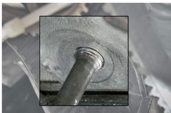
画像 1：スタッドが正しく固定されていない状態
